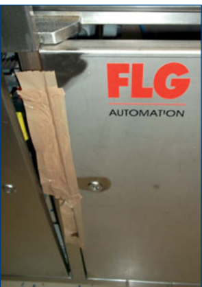
Abb. 3 Maßnahmenbeispiel - Provisorische Verriegelung wurde repariert
