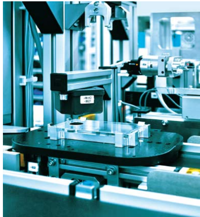
Auf dem Werkstückträger liegt der Rohling mit dem Funkdatenträger. Der RFID-Lesekopf erfasst die Auftragsdaten und löst entsprechend den nächsten Bearbeitungsschritt aus.
