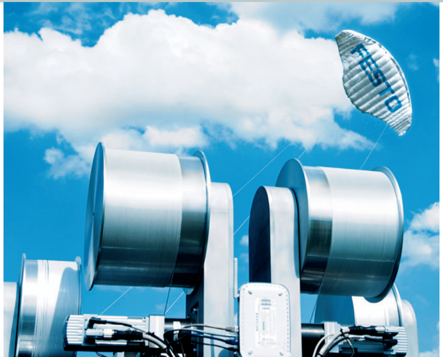
Hochfliegende Pläne: Das Drachensteigen-Lassen inspirierte Festo, gemeinsam mit dem Partner Aeroix das Projekt ›CyberKite‹ zu starten, bei dem ein Staudruckflügel von einer autonomen Steuereinheit stabil im Wind gehalten wird. Auf Basis dieses Prinzips lässt sich Energie aus Windkraft gewinnen
